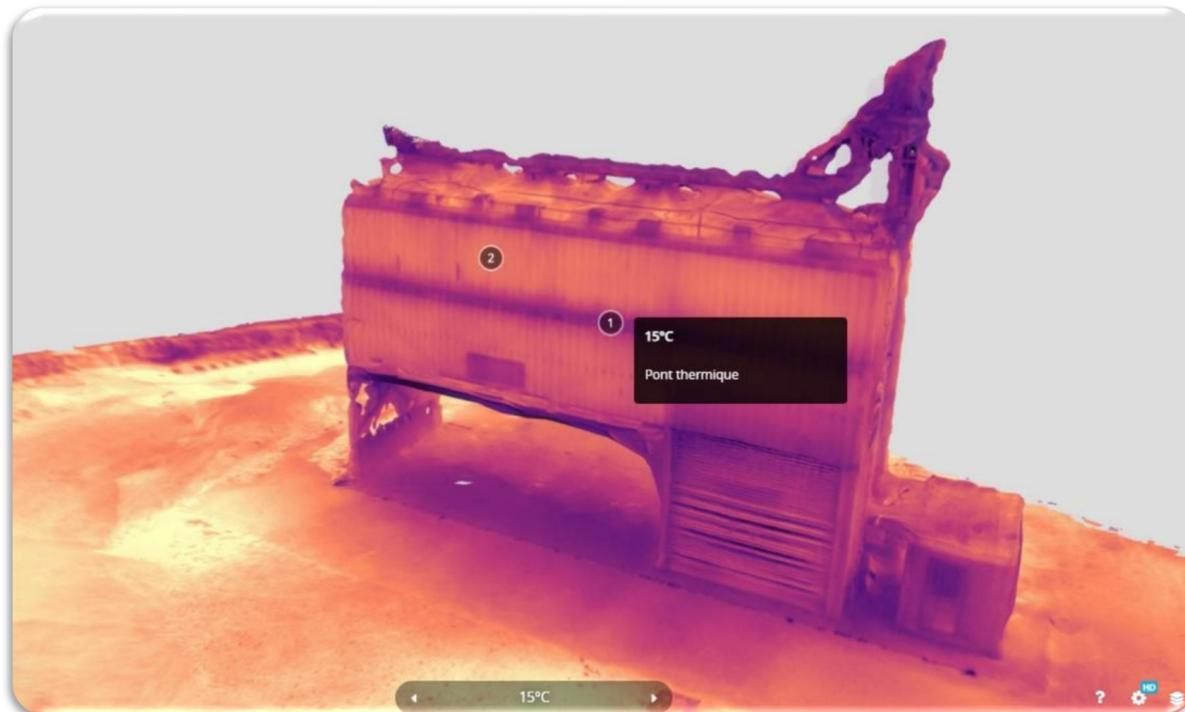
Détection d'un pont thermique sur un silo industriel
